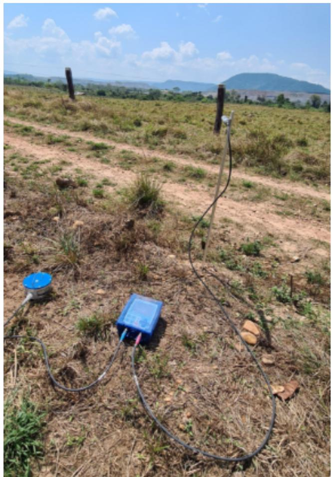
Figura 1: Monitoramento de vibração com sismógrafo
